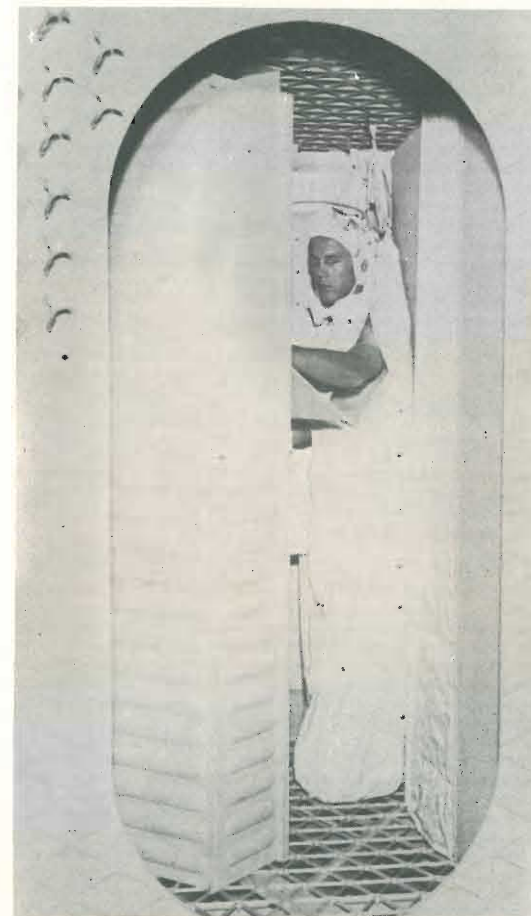
Cuccetta per il sonno munita di reofori per il controllo medico da terra. La posizione verticale non tragga in inganno poiché in assenza di gravità la posizione orizzontale o verticale non ha senso.
